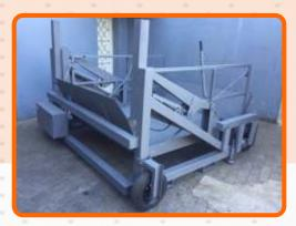
Para aplicação na carga e descarga de veículos, caminhões, semirreboques e containers ou como elevador para vencer desníveis.
